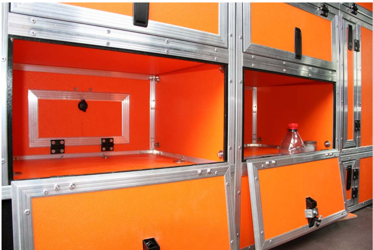
Pareto-Prinzip: viele Probleme kann man mit minimalem Aufwand lösen! Wir hatten lange überlegt die Schränke der Kontur des Defenders anzupassen um maximalen Raumgewinn zu bekommen. Der Aufwand solche Schränke zu bauen ist jedoch enorm. Mit der Serviceklappe in der Rückwand steht der gleiche Raum zur Verfügung: für den Wagenheber, die Schmutzwäsche, die Steinesammlung aus dem Urlaub, eben alles was sonst im Weg ist.
