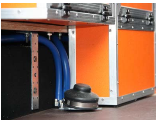
Fußraum: der Schrank vor dem Waschbecken hat einen „Unterschnitt“, dort sitzt die Fußpumpe und man kann vor dem Becken stehen.
