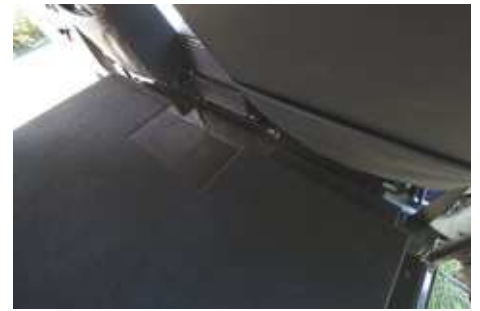
Zwischenboden mit Velour überzogen und in der Mitte der Ausschnitt für die Kühlbox.
