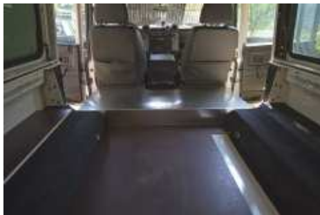
Vorne bereits der Zwischenboden und im hinteren Bereich die 18mm Siebdruckplatte.
