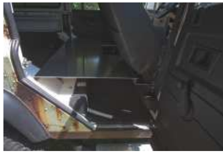
Beim Zwischenboden haben wir uns für ein gekantetes Aluminium (3mm) entschieden da wir Zugang zu einem kostengünstigen Spengler haben.
