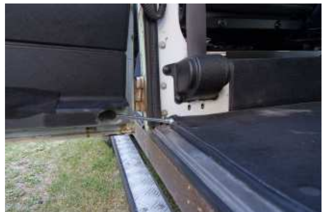
Um die Türen bis zu 90 Grad öffnen zu können haben wir bereits bei allen Türen die originalen Türbänder durch hydraulische Dämpfer ersetzt - dadurch lassen sich z.B. Boxen leichter entnehmen.
